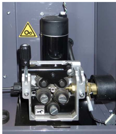
Trainafilo a 4 rulli 4-roller wire feeder Drahtvorschubeinheit mit 4 Rollen Entrainement à 4 galets e Arrastrahilo de 4 rodillos
