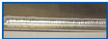
Saldatura alluminio Welding of aluminium
