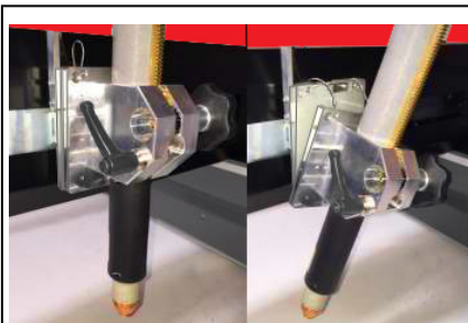
Sistema anti collisione della torcia Torch anti-collision system
