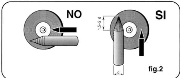
**ADVERTENCIAS:** PARTICULAS METALICAS INCANDESCENTES EN SUSPENSION pueden causar heridas al personal, dar origen a incendios o dañar los instrumentos de trabajo; LA CONTAMINACION CON TUNGSTENO puede disminuir la calidad de la soldadura.
