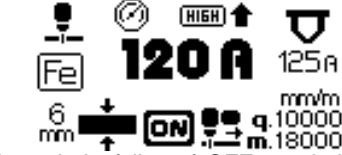
Die Funktion kann jedenfalls auf OFF geschaltet werden, damit der Betriebsdruck des Schneidbrenners direkt über die Hauptbedientafel abgelesen und auf den gewünschten Wert reguliert werden kann (innerhalb der voreingestellten Grenzwerte), die Bedientafel sieht dann wie folgt aus:
