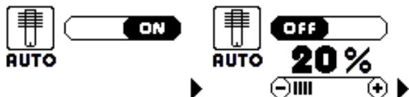
La modalité par défaut d'usine est AUTO ON, elle permet au générateur d'interrompre le fonctionnement automatique de manière autonome quand l'électrode et la buse sont à remplacer. Il est cependant possible de configurer cette modalité sur OFF, ce qui ne correspond pas à la désactivation complète de la fonction, mais il devient possible de pouvoir augmenter ou diminuer la sensibilité d'intervention de cette protection.
