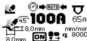
Il generatore visualizza automaticamente la larghezza e la profondità del solco ottenibile con i valori di corrente (Fig. 4 Rif. G) alla velocità di lavorazione relativa (Fig. 4 Rif. E) impostate dall'operatore e indica l'ugello da utilizzare (Fig. 4
