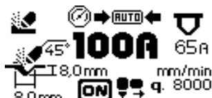
Le générateur affichera automatiquement la largeur et la profondeur du sillon pouvant être obtenu avec les valeurs de courant (Fig. 4 Réf. G) à la vitesse d'usinage correspondante (Fig. 4 Réf. E) configurées par l'opérateur et indique la buse à utiliser (Fig.4 Réf.F) et l'inclinaison en degrés à laquelle il faut garder la torche pendant l'avancement.
