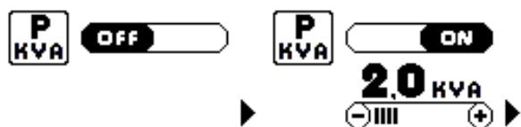
Der werkseitige Standardmodus ist OFF, was bedeutet, dass keinerlei Begrenzung der Stromaufnahme am Eingang vorliegt. Falls es jedoch notwendig ist, kann diese Funktion auf ON geschaltet werden, dann wird der Wert für die maximale Stromaufnahme gewählt, um den Generator an die Anlage anzupassen, mit der er verbunden wird. Auf diese Art kann er problemlos an alle Industrieanlagen angeschlossen werden, und Überlast und die entsprechenden Auslösungen der Schutzvorrichtungen werden vermieden.
