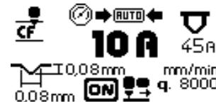
Le générateur affichera automatiquement la largeur et la profondeur du sillon pouvant être obtenu avec les valeurs de courant (Fig. 4 Réf. G) et la vitesse d'usinage correspondante (Fig. 4 Réf. E) configurées par l'opérateur et indique la buse à utiliser (Fig.4 Réf.F).
