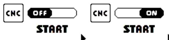
Configurando esta função em ON ativa-se a modalidade de START pelo CNC correspondente aos pinos 3 e 4 do conector AMP situado na parte traseira do gerador e desativa-se simultaneamente o start manual situado no adaptador frontal da máquina.
