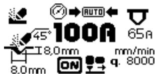
Der Generator zeigt automatisch die Breite und die Tiefe der mit den Stromwerten erzielbaren Rille (Abb. 4 Bez. G) bei
