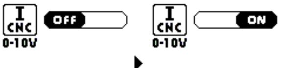
Der werkseitige Standardmodus ist OFF, was bedeutet, dass es keine ferngesteuerte Möglichkeit zum Regulieren des Schnittstroms zwischen dem Pin 1 (0 V) und dem Pin 2 (10 V) gibt.
