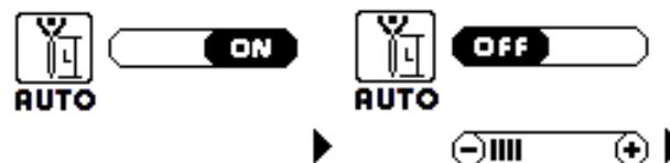
La modalidad por defecto de fábrica es AUTO ON, que permite que el generador regule automáticamente y sinérgicamente la longitud del arco piloto en función de la antorcha activada, de los consumibles instalados y del proceso de elaboración seleccionado. De todas formas, esta función puede configurarse en OFF para poder regular
