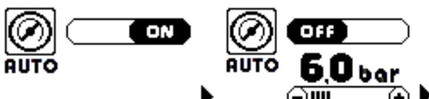
La modalidad por defecto de fábrica es AUTO ON, que permite que el generador mantenga constante y en un valor óptimo, la presión de trabajo de la antorcha, incluso en presencia de variaciones de la presión de entrada. De hecho, este sistema configurado en modalidad automática, permite que no se tenga que realizar ninguna regulación de la presión; será el generador el que configure el valor correcto en función de la antorcha activada y de la elaboración seleccionada.
