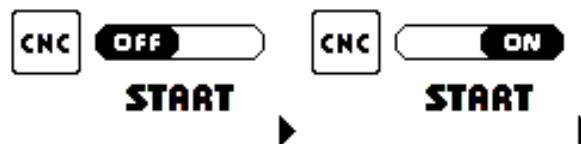
Configurando esta función en ON, se activa la modalidad de START por CNC correspondiente a los pin 3 y 4 del conector AMP situado en la parte trasera del generador y simultáneamente, se desactiva el start manual situado en el adaptador frontal de la máquina.
