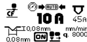
O gerador exibe automaticamente a largura e a profundidade do sulco que pode ser obtido com os valores de corrente (Fig. 4 Ref. G) e velocidade de trabalho relativa (Fig. 4 Ref. E) definidos pelo operador e indica o bico a usar (Fig.4 Ref.F).
