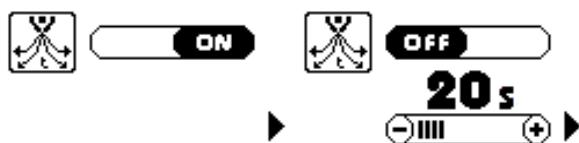
La modalidad por defecto de fábrica es AUTO ON, que permite que el generador regule automáticamente y sinérgicamente la duración del post gas en función de la antorcha activada, del valor de corriente configurado y del proceso de elaboración seleccionado. De todas formas, esta función puede configurarse en OFF para poder regular manualmente la duración del post gas (dentro de ciertos límites preconfigurados).
