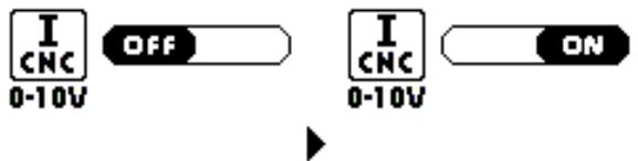
A modalidade padrão de fábrica é OFF [Desligado] o que implica que não haja qualquer possibilidade de regulação da corrente de corte remotamente entre o pino 1 (0V) e o pino 2 (10V).
