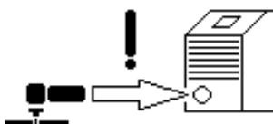
Caso apareça esta imagem a máquina sinaliza que não foi ligada qualquer tocha ou que foi ligada uma tocha inválida. Para restaurar o correto funcionamento é necessário desligar a máquina, ligar uma tocha válida e original entre aquelas disponíveis e voltar a ligar a máquina.
