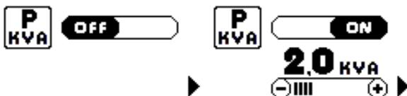
La modalité par défaut d'usine est OFF ce qui comporte qu'il n'y a aucune limitation de la puissance absorbée à l'entrée.
