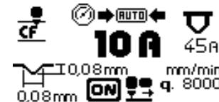
Il generatore visualizza automaticamente la larghezza e la profondità del solco ottenibile con i valori di corrente (Fig. 4 Rif. G) e velocità di lavorazione relativa (Fig. 4 Rif. E) impostate dall'operatore e indica l'ugello da utilizzare (Fig. 4 Rif. F).
