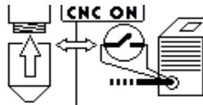
Nel caso in cui compaia questa immagine la macchina segnala che la funzione START CNC è attiva e occorre verificare che il portaugello non sia stato rimosso e/o che il contatto esterno della torcia automatica non sia rimasto aperto (quest'ultimo va infatti cortocircuitato per un corretto funzionamento dello start da cnc)
