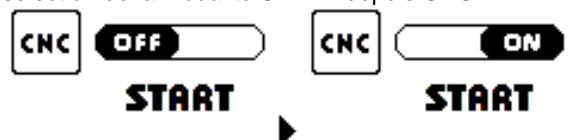
En configurant cette fonction sur ON on active la modalité de START depuis CNC correspondant aux pins 3 et 4 du connecteur AMP placé à l'arrière du générateur et on désactive en même temps le start manuel placé sur l'adaptateur frontal de la machine.
