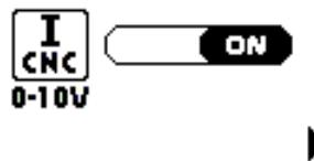
La modalità default di fabbrica è OFF il che comporta che non via sia alcuna possibilità di regolazione della corrente di taglio da remoto tra il pin 1 (0V) e il pin 2 (10V).
