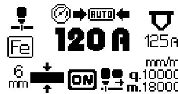
Si la presión de entrada fuera insuficiente para alcanzar el valor óptimo de corte, pero aun así, suficiente para el proceso seleccionado, la máquina mostrará la palabra LOW con una flecha dirigida hacia abajo.
