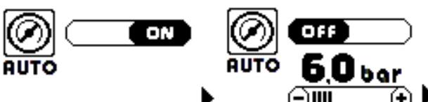
La modalità default di fabbrica è AUTO ON che permette al generatore di mantenere costante e al valore ottimale la pressione di lavoro della torcia, anche in presenza di variazioni della pressione di ingresso. Questo sistema impostato in modalità automatica consente infatti di non eseguire alcuna regolazione della pressione, sarà il generatore ad impostare il valore corretto in funzione della torcia inserita e della lavorazione selezionata.
