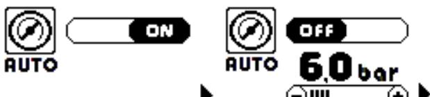
Der werkseitig eingestellte Standardmodus ist AUTO ON, sodass der Generator den Betriebsdruck des Schneidbrenners konstant und auf optimalem Wert beibehält, auch wenn am Eingang Druckschwankungen vorkommen. Dieses im Automatikmodus eingestellte System ermöglicht es, dass der Druck nicht reguliert werden muss, der Generator selbst stellt den richtigen Wert aufgrund des eingesetzten Schneidbrenners und der gewählten Bearbeitung ein.
