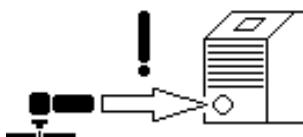
Si aparece esta imagen, la máquina señala que no se ha conectado ninguna antorcha o que se ha conectado una antorcha no válida.
