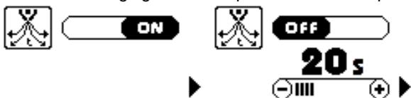
La modalité par défaut d'usine est AUTO ON qui permet au générateur de régler automatiquement et de manière synergique la durée du post gaz par rapport à la torche insérée, de la valeur de courant configurée et du processus d'usinage sélectionné. Il est de toute manière possible de configurer cette fonction en OFF, de manière à pouvoir régler manuellement la durée du post gaz (dans certaines limites fixées).
