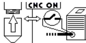
Si cette image s'affiche la machine signale que la fonction START CNC est activée et qu'il faut contrôler si le porte-buse n'a pas été enlevé et/ou si le contact externe de la torche automatique n'est pas resté ouvert (ce dernier doit en effet être court-circuité pour le fonctionnement correct du start du cnc).
