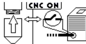
Caso apareça esta imagem a máquina sinaliza que a função START CNC está ativa e é necessário verificar que o suporte do bico não tenha sido removido e/ou que o contacto externo da tocha automática não tenha ficado aberto (a este último deve ser feito um curto-círcito para um correto funcionamento do start pelo CNC).
