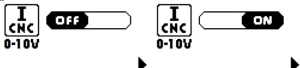
La modalidad predeterminada de fábrica es OFF, lo que implica que no hay ninguna posibilidad de regulación de la corriente de corte desde remoto entre el pin 1 (0V) y el pin 2 (10V).
