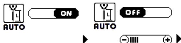
La modalità default di fabbrica è AUTO ON che permette al generatore di regolare automaticamente e sinergicamente la lunghezza dell'arco pilota in funzione della torcia inserita, dei consumabili installati e del processo di lavorazione selezionato. E' comunque possibile impostare questa
