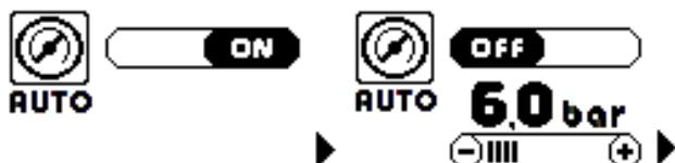
A modalidade padrão de fábrica é AUTO ON [AUTOMATICAMENTE LIGADO] que permite ao gerador de manter constante e ao valor ideal a pressão de trabalho da tocha, mesmo em presença de alterações da pressão de entrada. Este sistema configurado em modalidade automática permite, na verdade, não realizar qualquer regulação da pressão; será o gerador a configurar o valor correto em função da tocha inserida e do trabalho selecionado.
