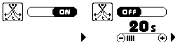
A modalidade padrão de fábrica é AUTO ON [AUTOMATICAMENTE LIGADO] que permite ao gerador de regular automaticamente e synergicamente a duração do pós-gás em função da tocha inserida, do valor de corrente definido e do processo de trabalho selecionado. De qualquer modo é possível configurar esta função em OFF [Desligado] de modo a poder regular manualmente a duração do pós-gás (dentro de certos limites predefinidos).
