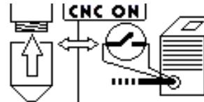
Wenn diese Abbildung erscheint, teilt die Maschine mit, dass die Funktion START CNC aktiviert ist und überprüft werden muss, ob die Düsenhalterung entfernt wurde und/oder ob der externe Kontakt des automatischen Schneidbrenners offen geblieben ist (letzterer muss für den korrekten Betrieb des über CNC gesteuerten Kontakts kurzgeschlossen werden).
