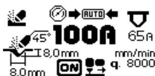
El generador mostrará automáticamente la anchura y la profundidad del surco que se obtiene con los valores de corriente (Fig. 4 Ref. G) a la velocidad de elaboración relativa (Fig. 4 Ref. E) configuradas por el operador e indicará la boquilla que hay que utilizar (Fig.4 Ref.F) y la inclinación en grados a la que debe mantenerse la antorcha durante el avance.
