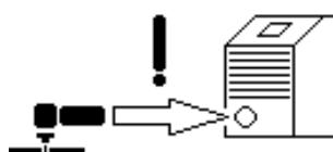
Falls diese Abbildung erscheint, teilt die Maschine mit, dass kein Schneidebrenner oder ein nicht gültiger Schneidebrenner angeschlossen ist.
