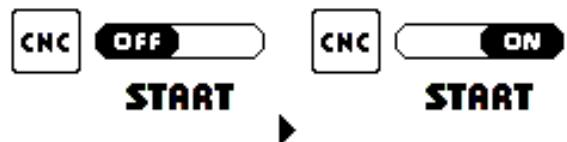
Wenn diese Funktion auf ON gestellt wird, wird der CNC-gesteuerte START-Modus aktiviert, der den Pins 3 und 4 des AMP-Verbinder auf der Rückseite des Generators entspricht, und gleichzeitig wird der manuelle Start am Adapter vorne an der Maschine deaktiviert.
