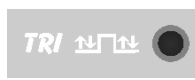
Led T soldadura Tig con tres niveles de corriente cuatro tiempos (automático).
