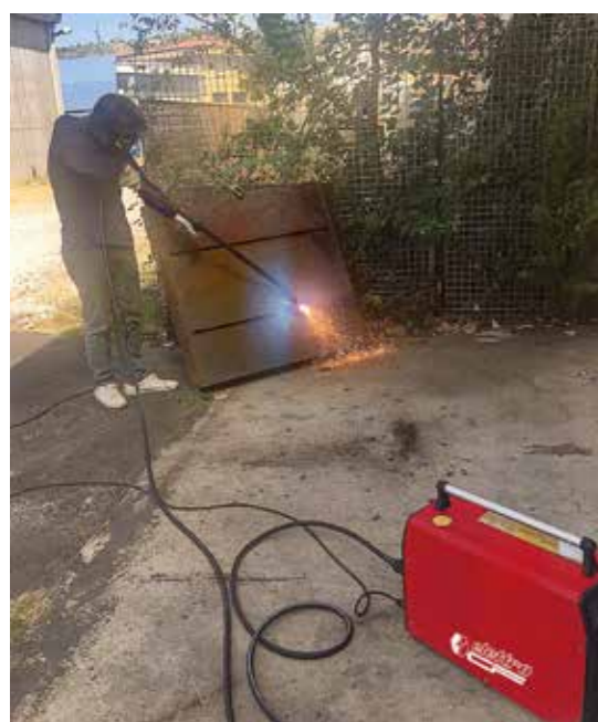
Code - Código 535472 Torche plasma manuelle ECF-131 angle à 15°, manche de 0,80 m et raccord EASY FIT. Antorcha de plasma manual ECF-131 ángulo a 15°, mango de 0,80 m y racor EASY FIT.
