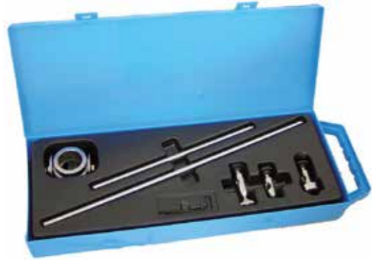
Fahrgestell für Kreisschneidevorrichtung. Wheeled torch holder
