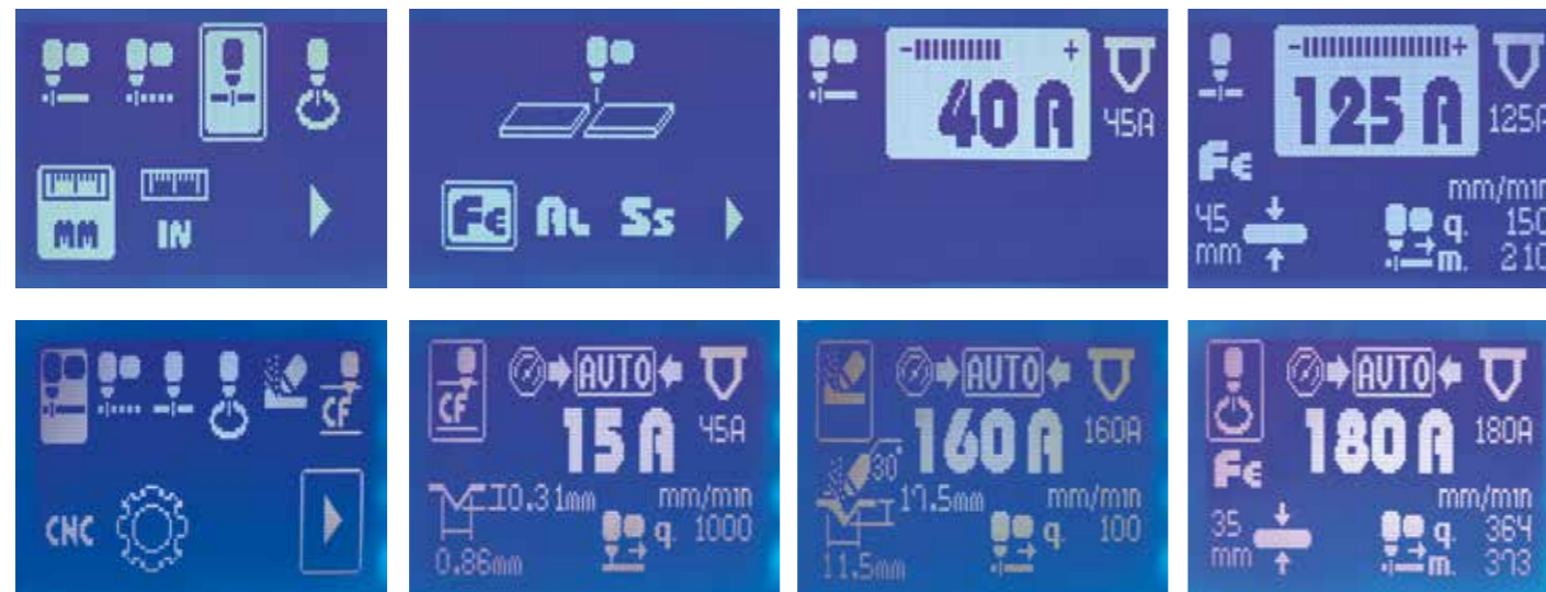
Einige Abbildungen des grafischen Display mit synergistischer Schnittstelle. Some images of the graphic display with synergic interface.
